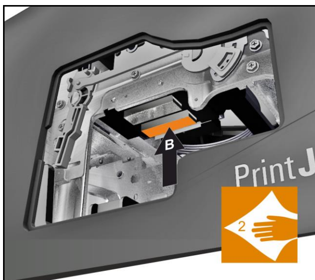
Figura 166 Limpar a cabeça de impressão B
