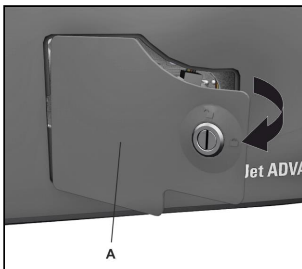
Figura 158 Remover a tampa de assistência técnica
