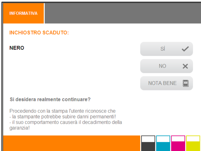
Figura 143 Touch panel – cartuccia di inchiostro scaduta
