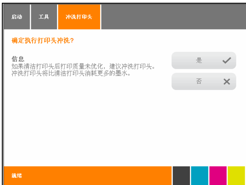
图 135 触摸面板 – 冲洗打印头
