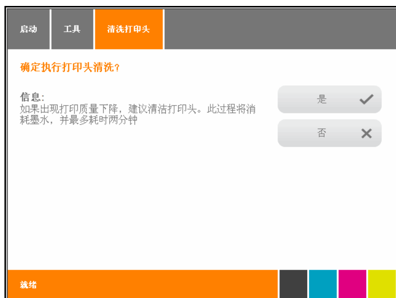
图 133 触摸面板 – 清洁打印头
