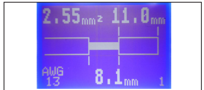
Bild 5.1 Anzeige mit Längeneinheit Millimeter
