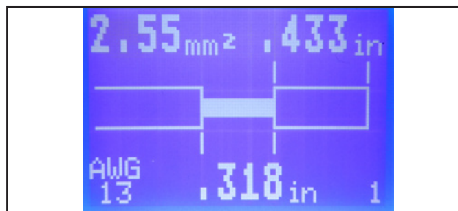
Ilustrace 5.2 Obrazovka s jednotkou délky – palce
