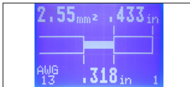
Afbeelding 5.2 Display met lengte-eenheid in inches
