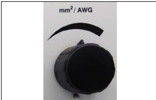
Imagine 5.3 Setarea secțiunii transversale
