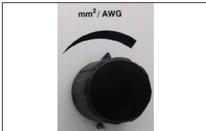
5.3 ábra A keresztmetszet beállítása
