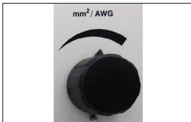
Ilustrace 5.3 Nastavení průřezu
