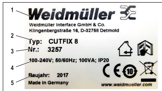
Bild 3.3 Märkplåten är placerad på maskinens baksida
