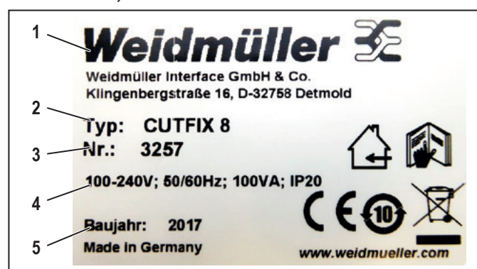
Imagine 3.3 Plăcuța de identificare este situată pe partea din spate a mașinii
