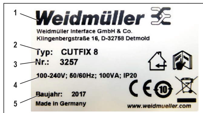
Ilustracja 3.3 Tabliczka znamionowa z tyłu maszyny
