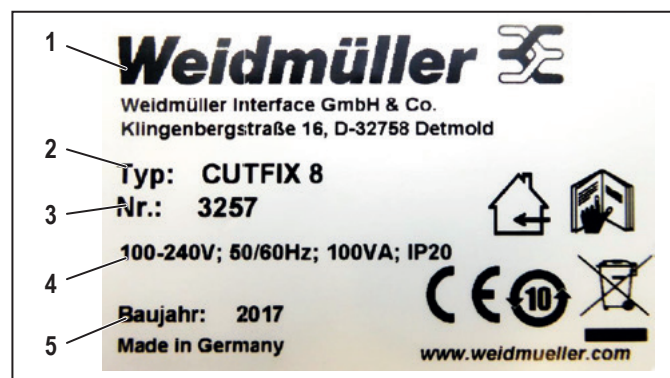
Bild 3.3 Typenschild an der Rückseite des Automaten
