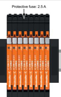
**de** Direkteinpeisung: Die Versorgungsspannung 24 V DC ±30 % kann direkt am Gerät angeschlossen werden. Über Leiterbrücken können so bis zu 130 Geräte gespeist werden. Sicherungseigenschaft: Die 2,5 A Sicherung muss bei 6,4 A nach spätestens 120 Sekunden auslösen.
