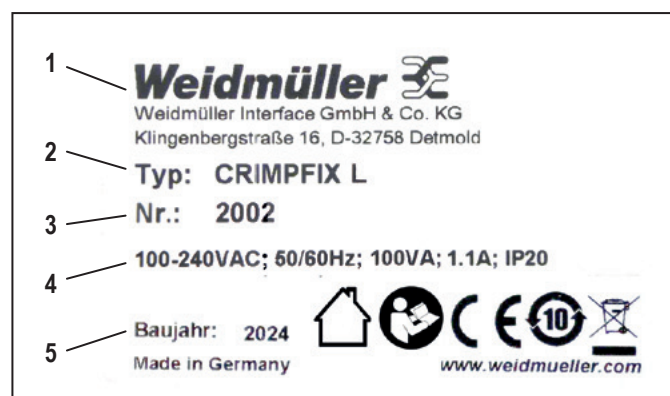
Ilustrace 3.3 Typový štítek je umístěn na zadní straně stroje
