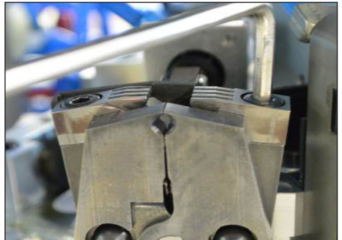
Figura 7.7 Rimozione delle matrici di crimpatura PZ3
