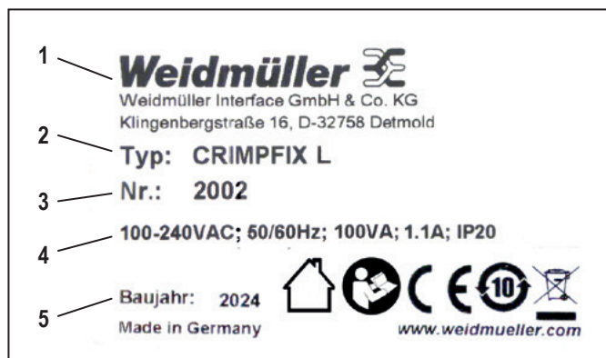
Figura 3.3 Targhetta modello sul retro della macchina
