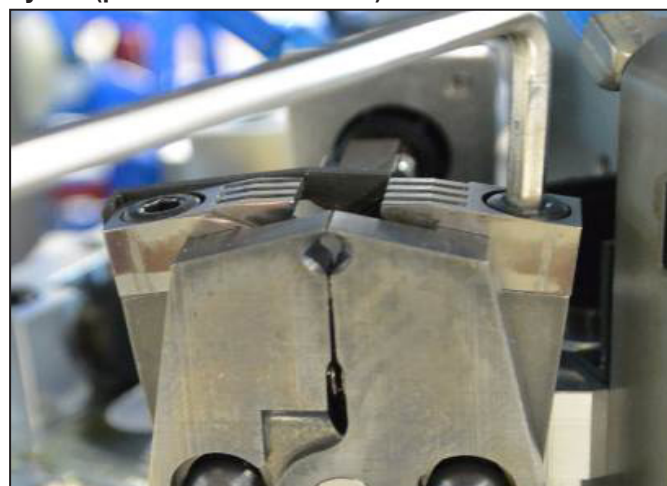
Ilustrace 7.7 Odstranění krimpovacích zápustek PZ3
