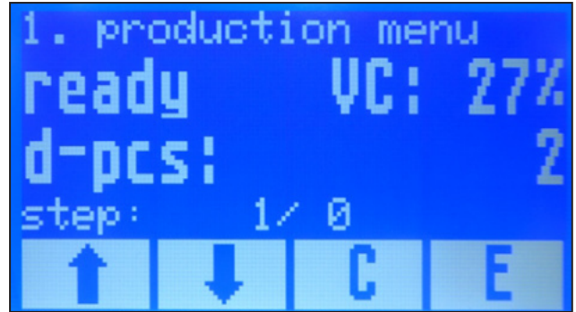
Kuva 6.2 Kosketusnäyttö; näyttö aktivoinnin jälkeen
