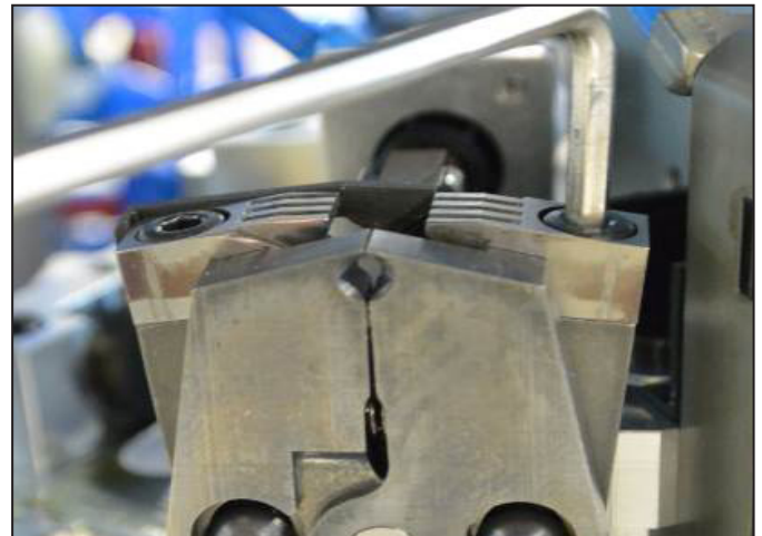
Bild 7.7 Ta bort PZ3 crimpformer
