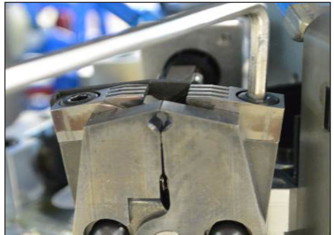
Figura 7.7 Remover matrizes de cravação PZ3
