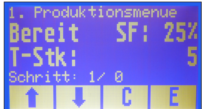
Bild 6.2 Touchdisplay, Anzeige nach dem Einschalten
