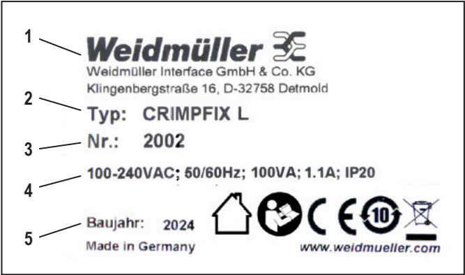
Рисунок 3.3 Типовая табличка на задней стороне станка
