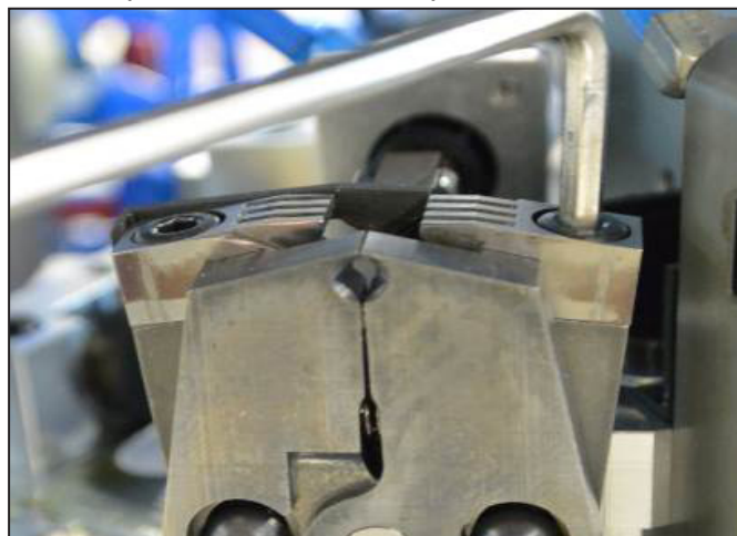
ábra 7.7 A PZ3 krimpelő szerszám eltávolítása
