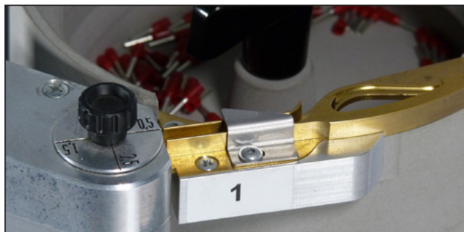
Рисунок 5.1 Колесо регулировки сечения обжимного наконечника (установка: 0,5)
