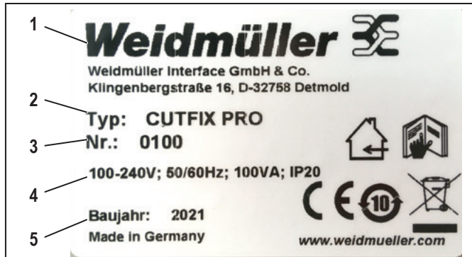
Bild 3.3 Typenschild an der Rückseite
