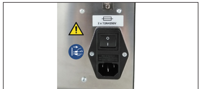
Bild 2.2 Warnsymbole an der Rückseite
