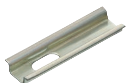
TS 15x5,5 mm acc. EN 60715 (t=1,0 mm)
