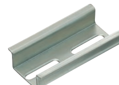
TS 35x15 mm acc. EN 60715 (t=1,5 mm)
