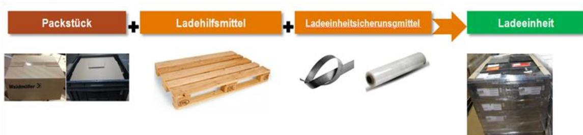
Abbildung 3: Bestandteile einer Ladeeinheit
