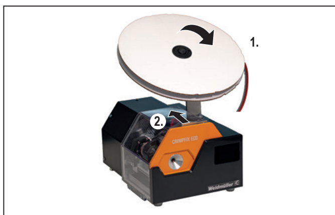
Ilustr. 6.1 Założenie krążka na tulejki kablowe
