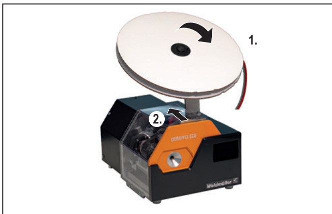
Afbeelding 6.1 Rol met adereindhulzen plaatsen
