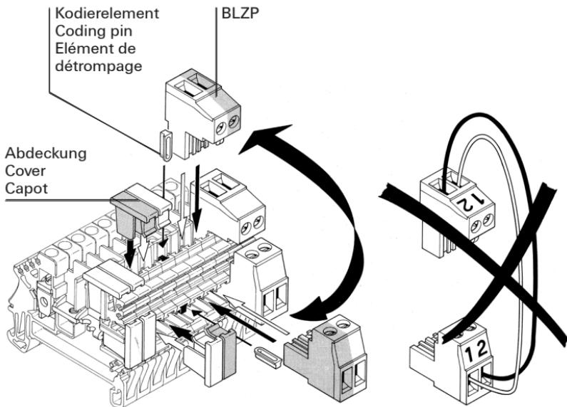
Werden die Steckverbinder BLZP vertikal **und** horizontal gesteckt (180°-Drehung), so muss bei der Verdrahtung auf die richtige Polung geachtet werden!
