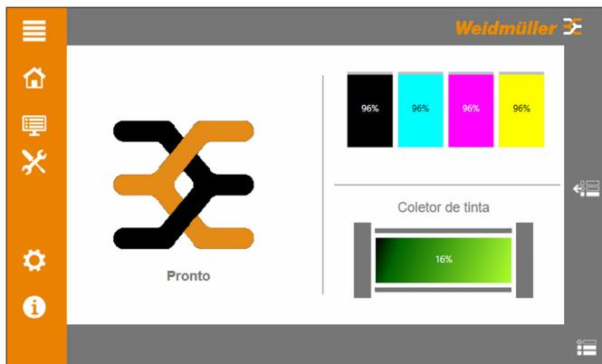
Figura 4.17 Painel tátil - menu principal Estado do sistema
