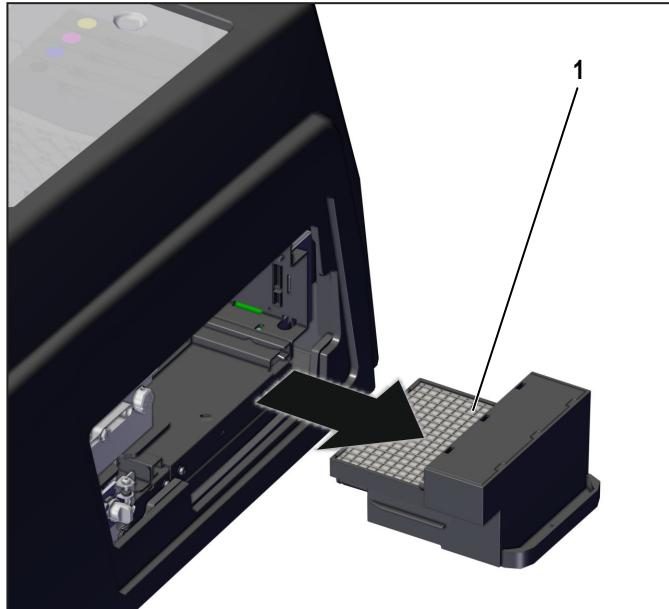
Figura 6.16 Remover o coletor de tinta para fora.
