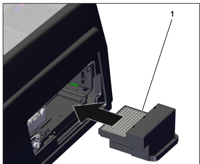
Figura 6.18 Empurrar o coletor de tinta
