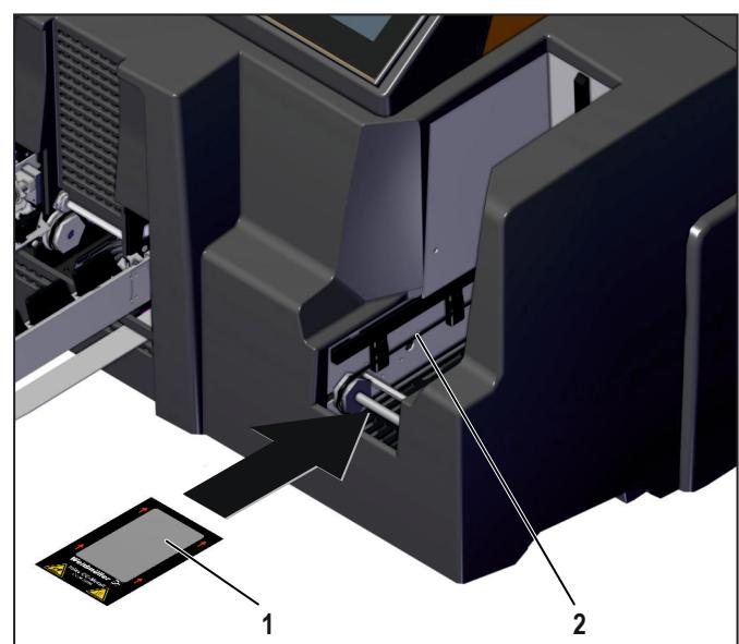
Figura 5.6 Inserir um MetalliCard isolado no inlay
