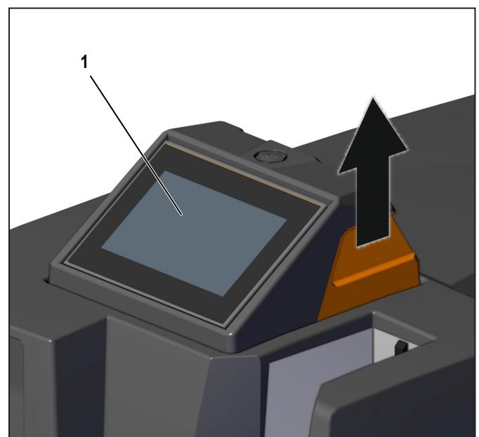
Figura 4.5 Painel tátil a posição “Operação lado transversal”
