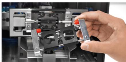
Schnellwechselwerkzeug für extrem kurze Rüstzeiten
