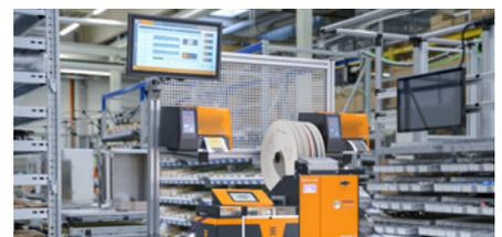
Modulares System kommunikationsfähiger Kabelbearbeitungsmaschinen und Drucker
