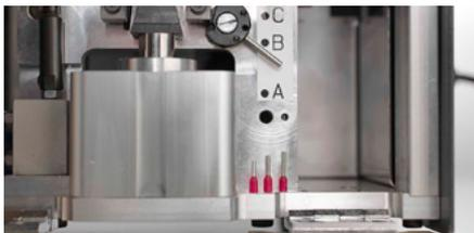
CRIMPFIX LS: drei verschiedene Crimplängen – ohne Werkzeugwechsel
