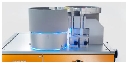
Der CA 100 DUO kann zwei Querschnitte parallel verarbeiten, sodass alle beim Querschnittswchsel erforderlichen Arbeitsschritte entfallen
