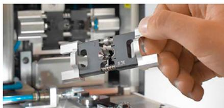
Schnellwechselwerkzeug für extrem kurze Rüstzeiten
