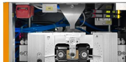
Der elektropneumatische Antrieb garantiert eine prozesssichere Verarbeitung und zeichnet sich durch einen robusten Aufbau sowie eine lange Lebensdauer aus
