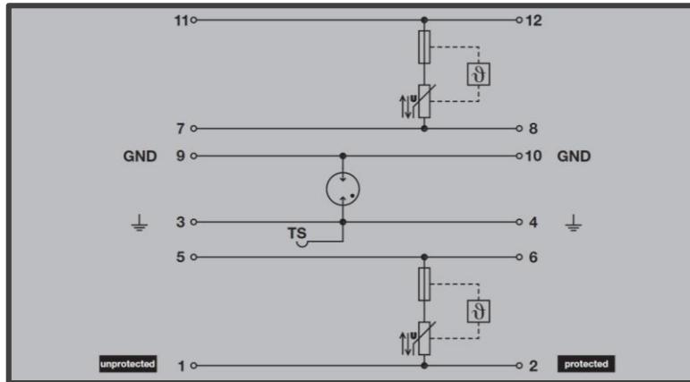
Bei diesem Modul leiten die Schutzelemente nicht „gegen PE“ ab (Gleichtaktstörungen), sondern arbeiten zwischen den aktiven Leitern (Gegentaktstörungen).
