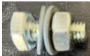
Abbildung 3: Referenzzusammensetzung von Schraube, Mutter und Unterlegscheiben.
