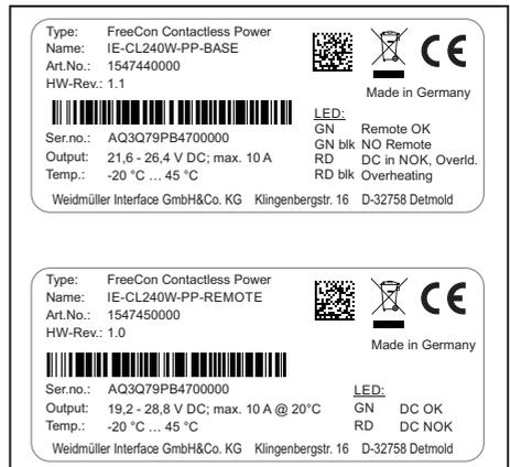
Typenschilder Primärseite und Sekundärseite
