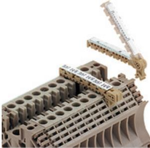
Групповые держатели этикеток SchT 5 S крепятся непосредственно на монтажную рейку TS 32 (G-образная рейка) или TS 35 (рейка цилиндрической формы). Поэтому клеммные колодки можно маркировать вне зависимости от клемм и типа клемм. SchT 5 и SchT 5 S оснащены защитными полосками ESO 5, STR 5.
