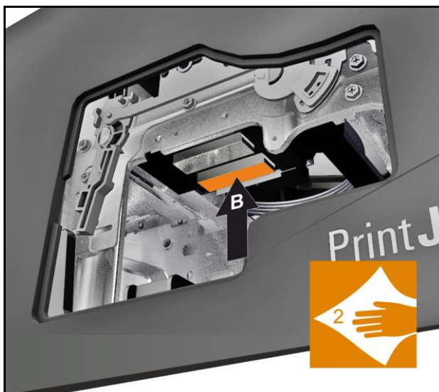
Figure 166 Nettoyer la tête d'impression B
