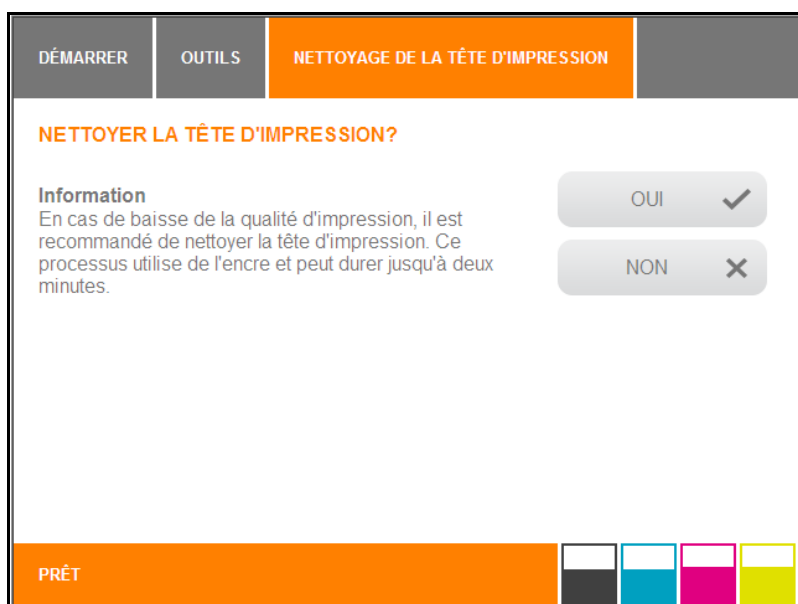
Figure 133 Écran tactile – Nettoyage de la tête d'impression
