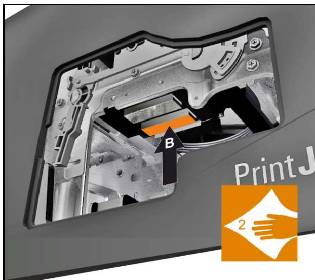
Figura 166 Limpiar el cabezal de impresión B
