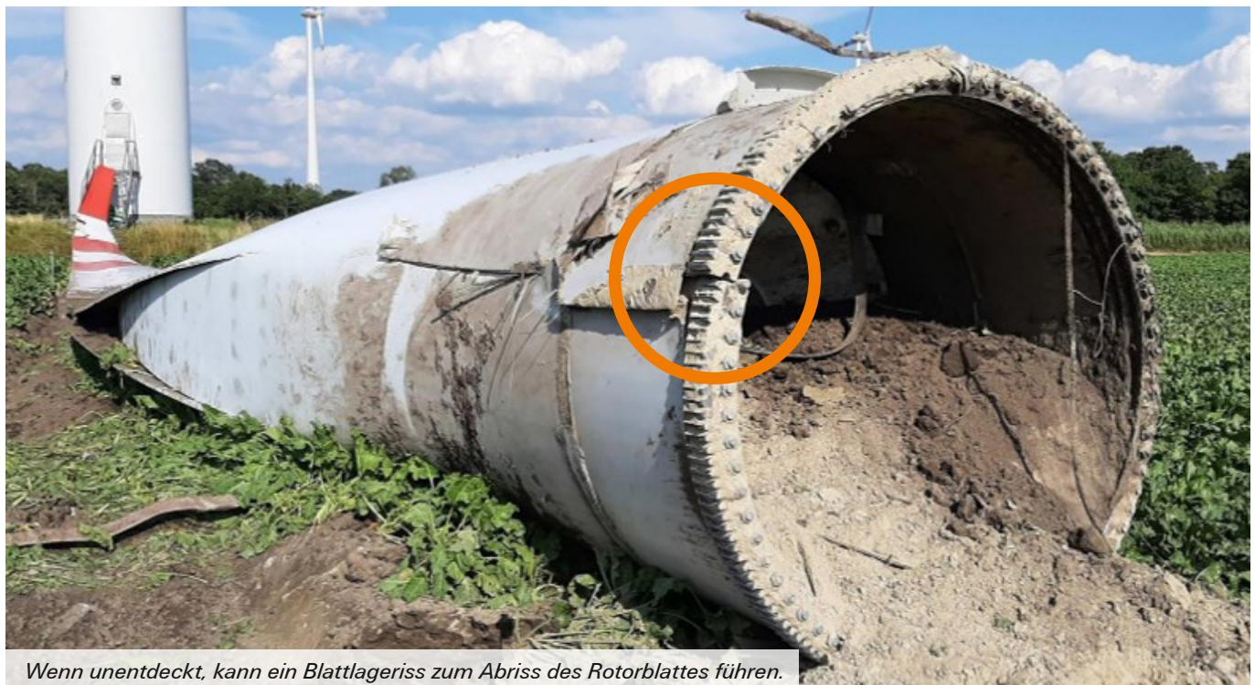
Wenn unentdeckt, kann ein Blattlageriss zum Abriss des Rotorblattes führen.
